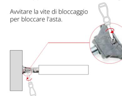
**FISSAGGIO A MURO:** La staffa di fissaggio è fornita già assemblata e pronta per l'installazione. Basta fissarla al muro con 2 viti D5 e i tasselli corrispondenti. Consigliamo di montare gli scaffali su un supporto adeguato (in agglomerato, mattoni, cemento, legno, ...).
